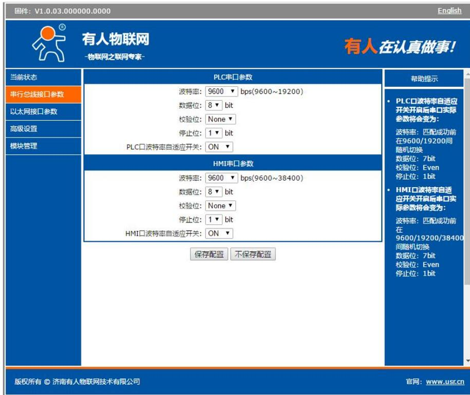
图 10 串行总线接口参数
